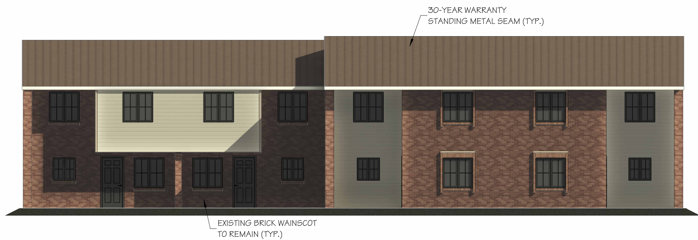
9 BLDG. TYPE "G" REAR ELEVATION API3 SCALE: 1/8" = 1'-0"
